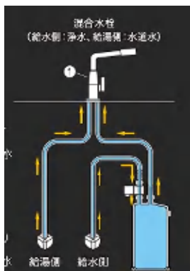
混合1本に設置
