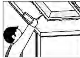
天窓に継ぎ目の充填、止水効果
