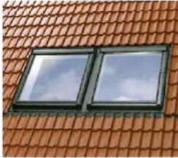
ベルックス連窓水切りは、デザイン設計にあわせて何列にでもつなげることができます。縦寸法 (H)、横寸法 (W)のいずれかが同じであれば、異なるサイズとの連窓も可能です。特注することなく純正の水切りで施工できるため見た目にも美しく、施工性に優れています。天窗の間隔は100mm空けてください。
