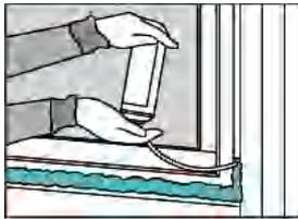
窓枠の断熱・結露防止
